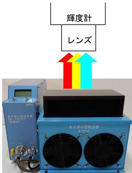
[制御部 + 空冷式恒温槽部] (水冷式にはチラーが付属)
